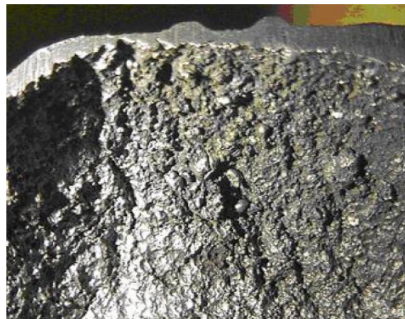
Imagen 10. Cavitación en válvula de mariposa.
