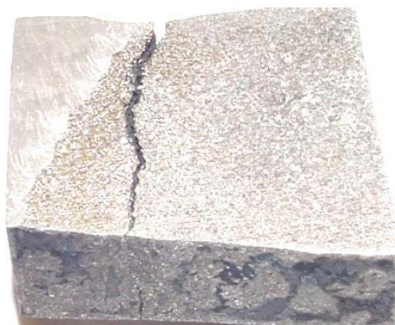
Imagen 6. Falla por agrietamiento y fatiga.
