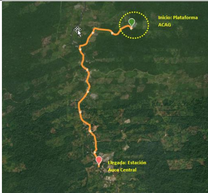
Figura 1. Trayectoria ducto 10in desde Plataforma ACAG hasta Estación Auca Central, total 4.1 km.
